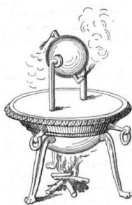
FIG. 1.3 – L'Éolipile d'Héron d'Alexandrie
