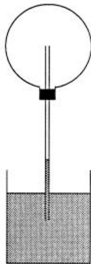
FIG. 1.1 – Thermoscope à air de Galilée
